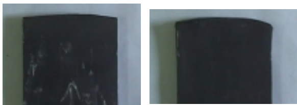
(a) かみ戻し (ΔT 1 /T 0 =20%, ΔT/T 0 =40%) (b) 通常 (ΔT/T 0 =40%) 図3 かみ戻し圧延と通常の圧延による先端クランプ形状の比較
