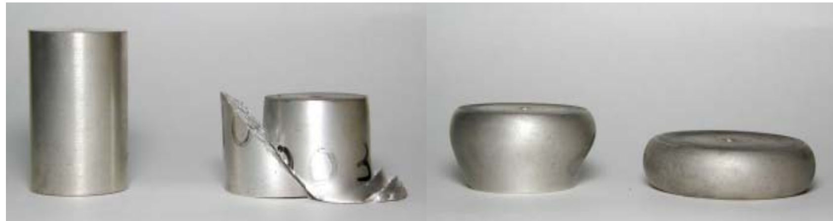
(a) 初期状態 (b) 割れ (c) マッシュルームのような不安定な変形 (d) 樽型の変形
