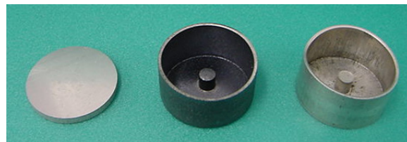
(a) 初期状態 (b) 潤滑剤: 黒鉛 (c) 液体潤滑油使用
