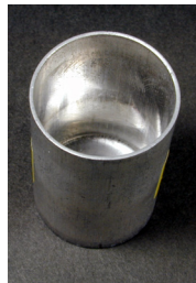
図 無潤滑後方押し出し加工(加工温度300°C, 加工速度150mm/s, 外径23.6mm, 底厚1.0mm)
