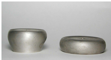
(c) 不安定変形 (d) 安定変形 (250°C) (300°C)
